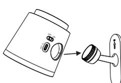
2. Put the lamp close to the joint head of the lamp bracket to connect automatically, and rotate the lamp to adjust the ideal lighting angle / lacez la lampe près de la tête articulée du support de lampe pour se connecter automatiquement, et faites pivoter la lampe pour ajuster l'angle d'éclairage idéal.
