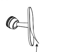
1. Remove the protective film from adhesive tape, now press the bracket directly onto the wall. / Retirez le film protecteur du ruban adhésif, puis appuyez le support directement sur le mur.
